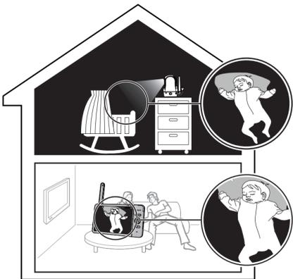
Die Babyeinheit hat Infrarot-LEDs, was Ihnen ermöglicht, Ihr Baby auch bei Nacht und Dunkelheit zu sehen. Wenn die Babyeinheit niedrigere Helligkeitsstufen erkennt, gehen die Infrarot-LEDs automatisch an. Die auf die Elterneinheit übertragenen Bilder sind schwarz-weiß. Auf dem Bildschirm der Elterneinheit erscheint dieses Symbol.
