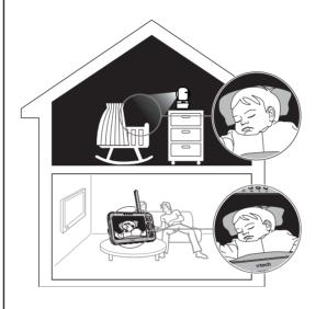
L'unité Bébé possède une caméra infrarouge qui s'active automatiquement lorsque l'intensité lumineuse de la pièce diminue. Elle permet de voir Bébé dans une pièce peu éclairée, ainsi que dans le noir total. Les images sont retransmises en noir et blanc sui l'écran de l'unité Parents et l'icône 📞 apparaît
