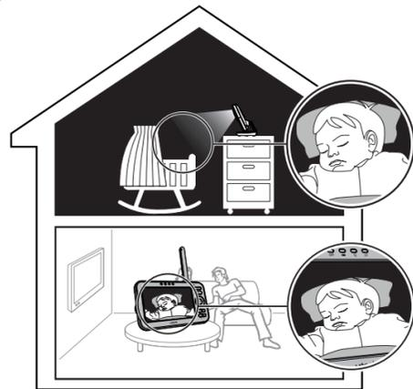
Die Babyeinheit hat Infrarot-LEDs, was Ihnen ermöglicht, Ihr Baby auch bei Nacht und Dunkelheit zu sehen. Wenn die Babyeinheit niedrigere Helligkeitsstufen erkennt, gehen die Infrarot-LEDs automatisch an. Die auf die Elterneinheit übertragenen Bilder sind schwarz-weiß. Auf dem Bildschirm der Elterneinheit erscheint ☾.
